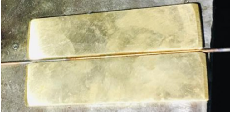
Figure 7.6: Bakır Eklem Kaynağı
