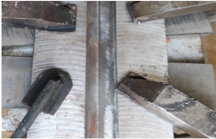
Şekil 1.7: Bağlama Aparatı Kullanarak Kaynakta Büzülmenin Önlenmesi
