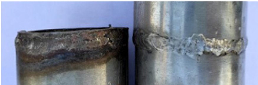
Şekil 8.1: Paslanmaz Çelik Kaynak Metalinin Oksitlenmesi
