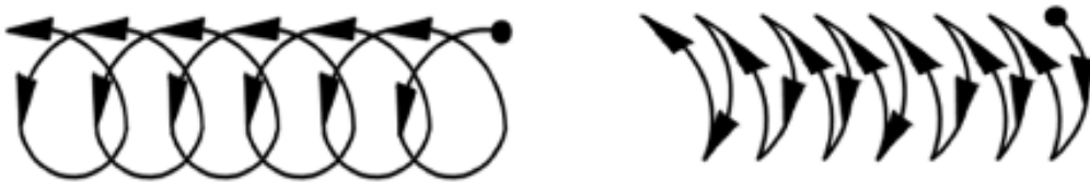
Şekil 1.16: Dolgu Geçişleri İçin Önerilen Elektrot Hareketleri
