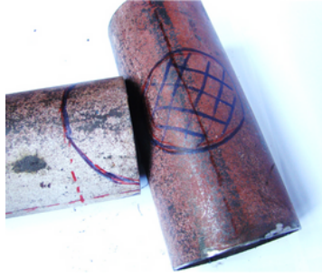
Şekil 9.16: Kesitleri Kesilmiş ve Kenar Açılmış Borular, Parçalı Dirsek Oluşturacak Şekilde
