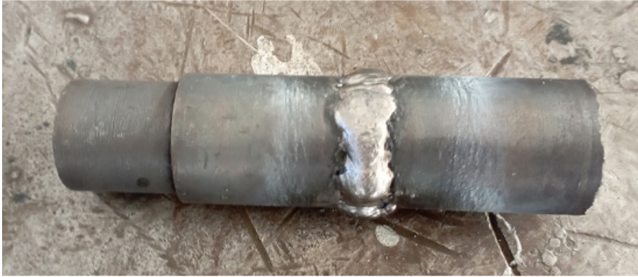
řekil 6.10: Kaynak Yapılmıř Kırık Dkme Demir
